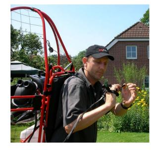
THE ENGINE RUNS WITH A 1:50 FUEL/OIL MIXTURE (2% 2T CASTROL SUPER WITH 95 OCTANE FUEL).
